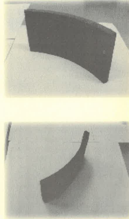
Fotografías tomadas en el GIGA: Grupo de Ingeniería y Gestión Ambiental. Grupo categoría A COLCIENCIAS. Universidad de Antioquia. Facultad de Ingeniería. giga.ingeniería@udea.edu.co. Muestra: a) el polvo que se usa en la fabricación de bandas de frenos ya mezclados, b) una piedra de asbesto en "bruto", y c) las bandas como tal, que se venden en el mercado automotriz por referencias.
